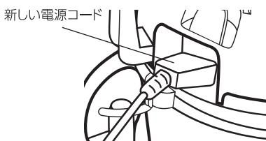
新しい電源コードを差し込み、カバーを元に戻します。
