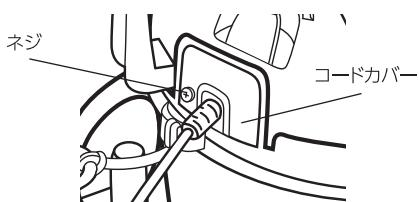
コインなどで電源コードカバーのネジを外します。
